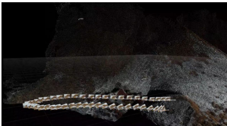
3. ábra. Szinképhelyes pontfelhő a rögzített képek térbeli helyzetével
