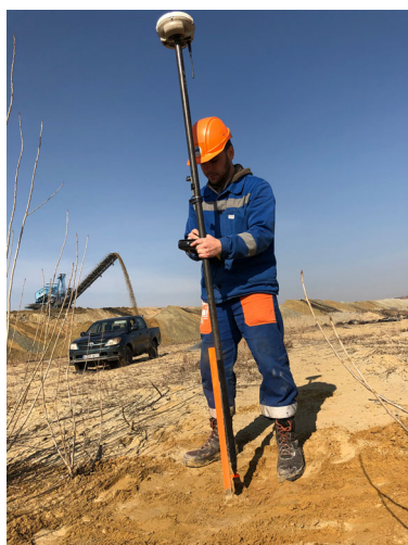
3., 4. ábra. Hányóvizsgálati monitoringpont bemérése GPS-vevővel
