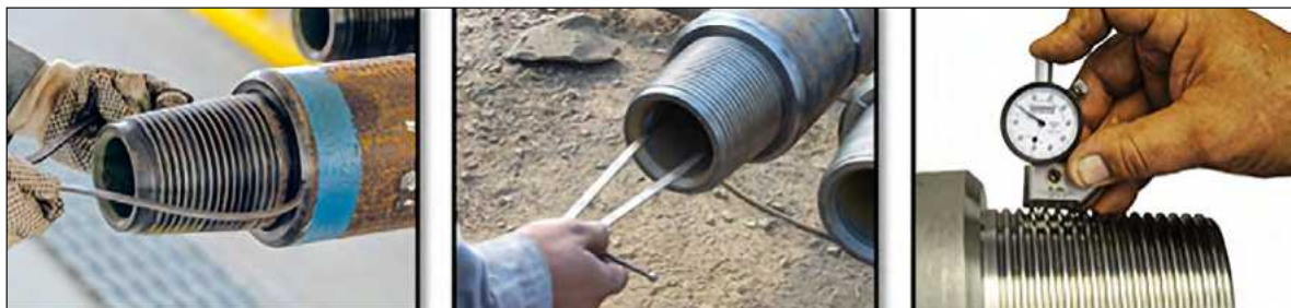
14. ábra. Fűrészárcapcsoló menetének geometriai vizsgálata
