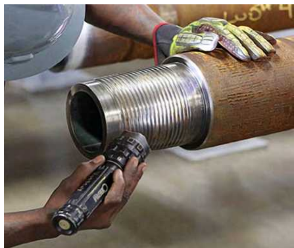
7. ábra. Menetvizsgálat ultraibolya fénnnyel
