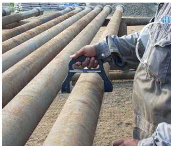
8. ábra. A külső átmérő ellenőrzése
