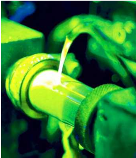
11. ábra. Nedves mágnesesrészecske-vizsgálat
