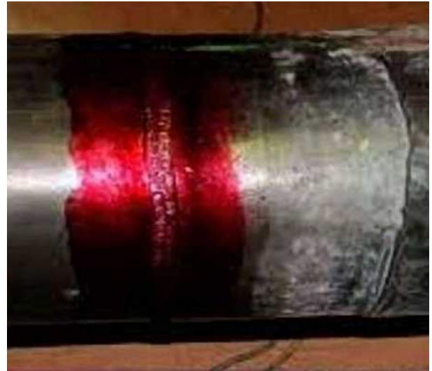
12. ábra. Folyadék- vagy festékáteresztő vizsgálat
