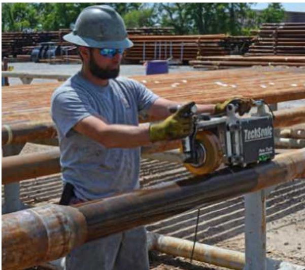
13. ábra. Ultrahangos vizsgálat
