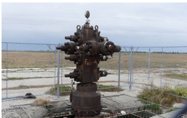
5. ábra. A Fábiánsebestyén-4. kút kútfejszerelvénye a karácsonyfával
