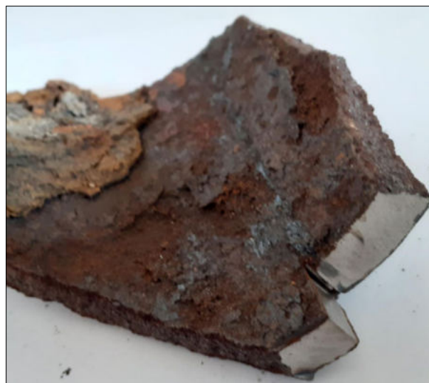
6. ábra. A XIX. század második felében gyártott pesti öntöttvas vízvezetékcső vizsgált darabja. A képen látható a belső korróziós és lerakódási réteg, valamint a metallográfiai vizsgálatokhoz kifűrészelt mintavételi hely
