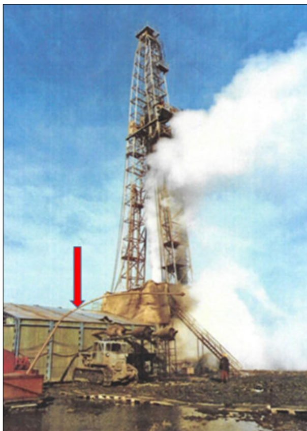
2. ábra. A gőzkitörés. A piros nyíl mutatja azt a súlyosbítót, amely a főfűrőmester halálát okozta 1
