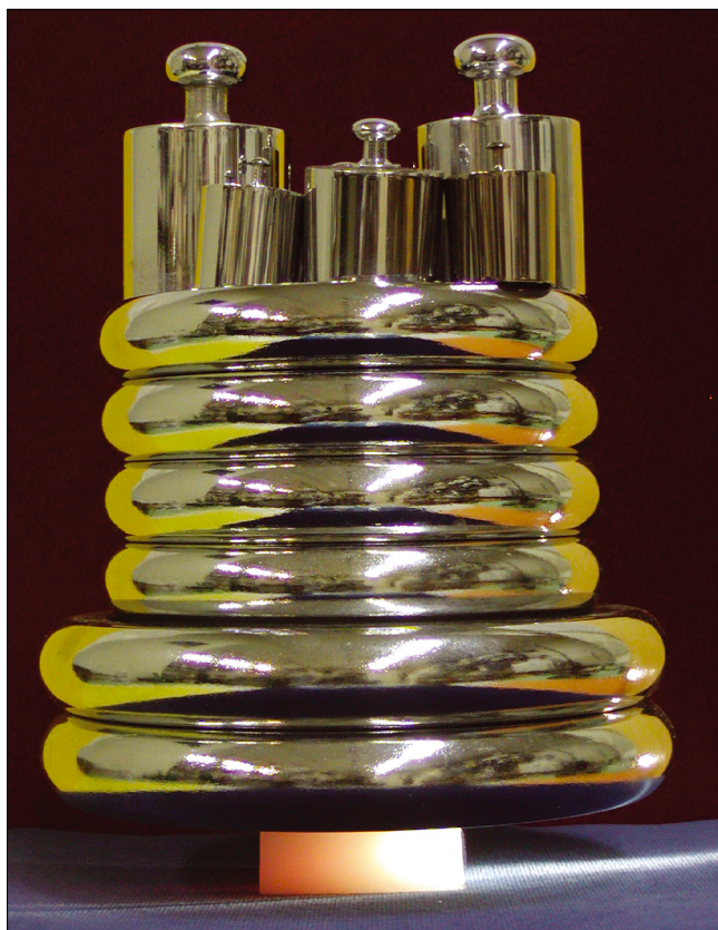
3. ábra: Monolitikus szilika aerogél teherbírásának szemléltetése. A képen egy 2,6 g tömegű aerogélhasáb 9400 g tömeget, azaz saját tömegének mintegy 3600-szorosát tartja károsodás nélkül.
