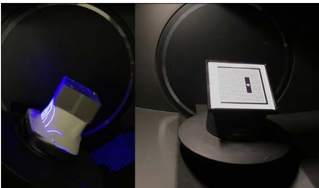
11. kép: Az artikulátor paramétereinek kalibrálása az asztali szkennelben
