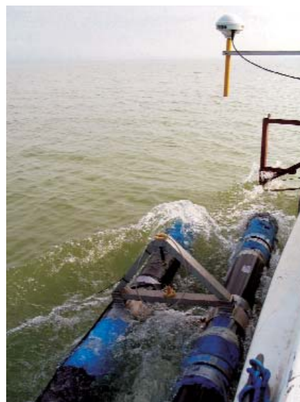
3. ábra. Egysatornás szeizmikus mérőműszer (Seistec) mérés közben, a hajó mellé rögzített helyzetben
