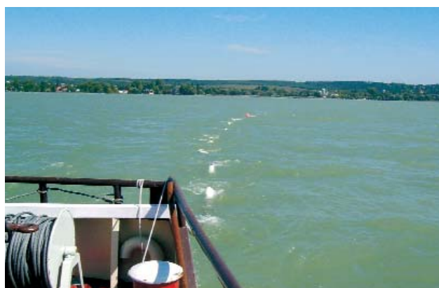
4. ábra. Többsatornás mérés során a hajó hosszú kábelhez rögzített hidrofonfüzért vontat
