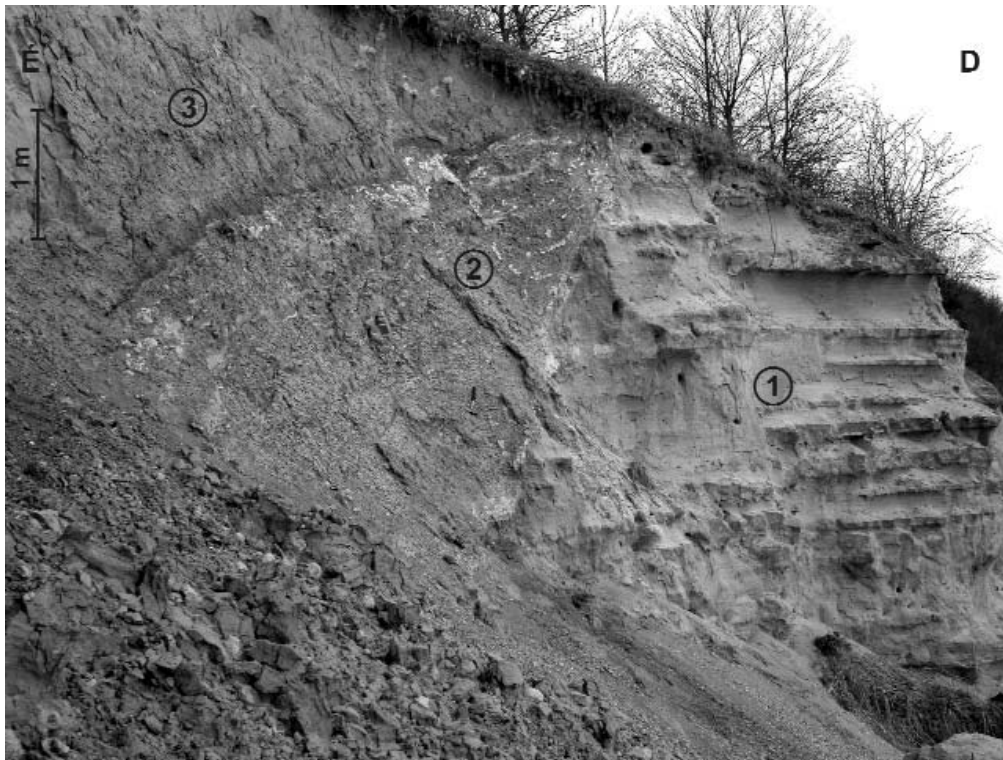
21. ábra. Vetők Komló-Mecsekjános hulladéklerakójának déli feltárásában 1 – homok-homokkő összlet (kárpáti), 2 – rétegzett közelsztes agyagmárga (badeni), 3 – lösz (pleisztocén)
