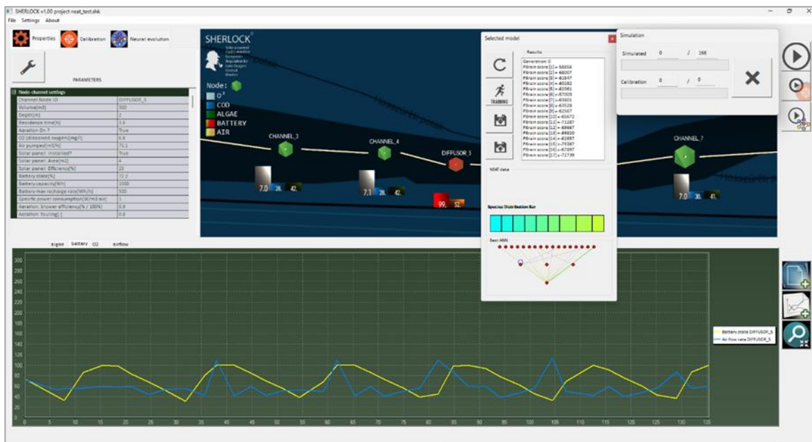
27. ábra. A SHERLOCK prototípus, napelen vezérelt levegőztetés automata tervezési folyamat közben, neuro-evolúciós algoritmus alapú gépi tanúlással (Kocsos T. 2023)
