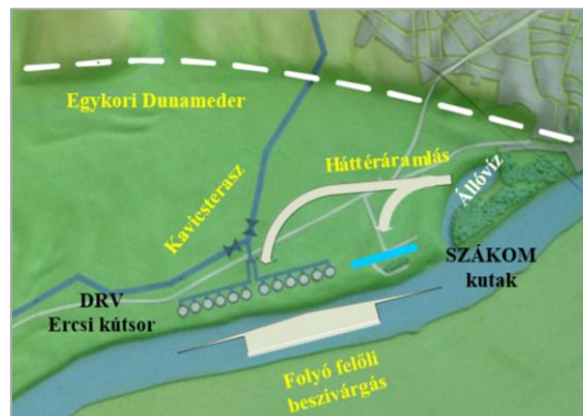
12. ábra. A vízbázis fő beszívargása és háttéráramlása az Ercsi kútsor sématabla képen
