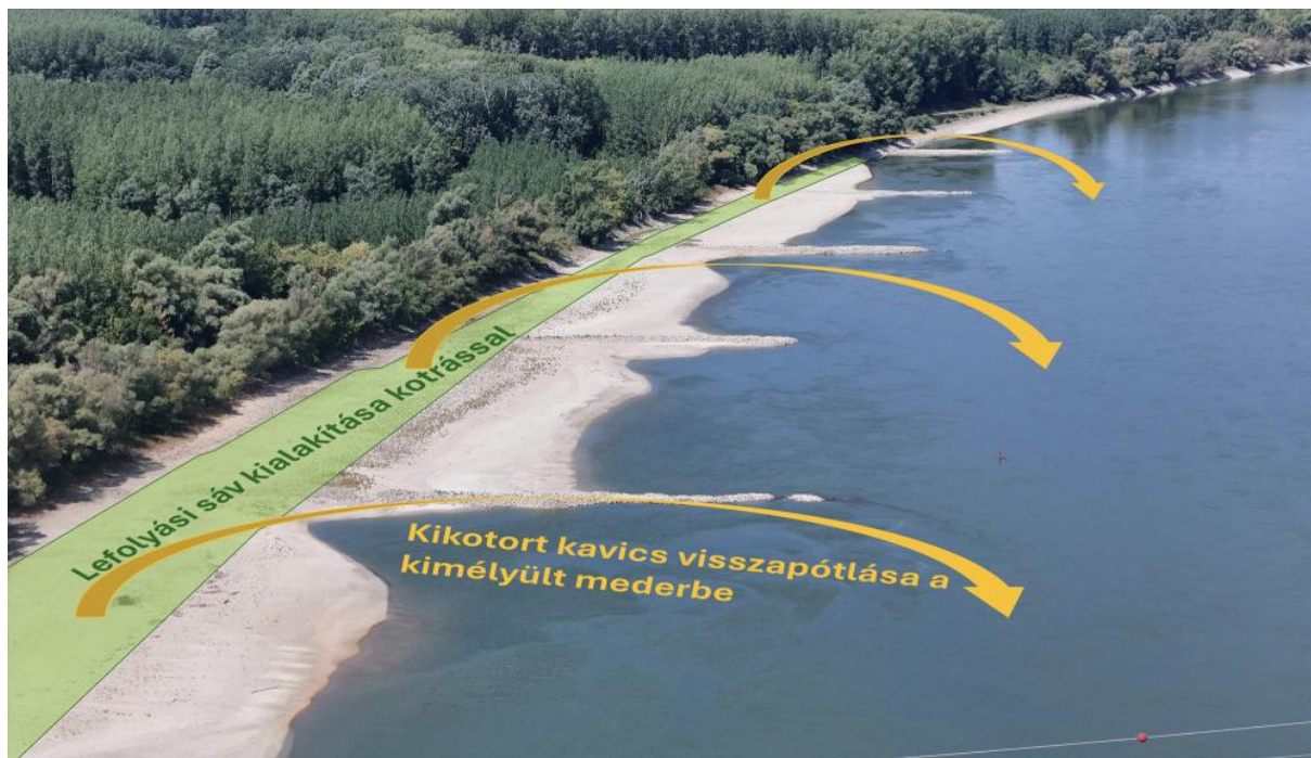
2. ábra. A Duna városszabadi szakaszán kialakult medermélyülés mérséklése ( iNNO SED projekt ) Figure 2. Mitigation of the riverbed depression in the Városszabadi section of the Danube ( iNNO SED projekt )
