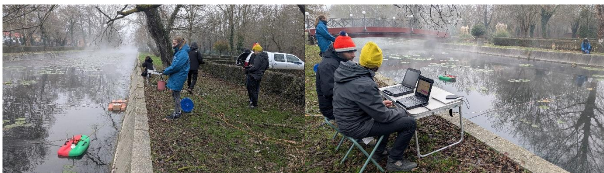
1. fénykép. A Déli-zsilipnél végzett közös vízhozammérés a Nyugat-dunántúli Vízügyi Igazgatósággal
