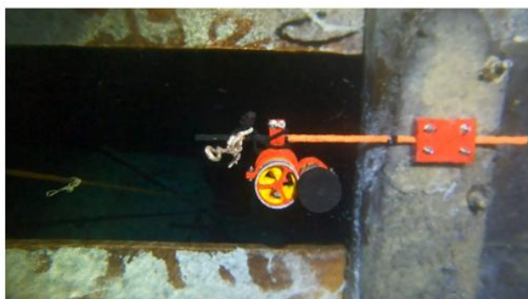
2. fénykép. Saját fejlesztésű áramlásmérő kalibrációja és elhelyezése a forrásbarlang bejáratánál Photo 2. Calibration and installation of the in-house developed flow meter at the entrance to the spring cave
