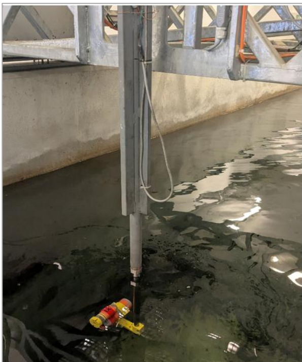
2. fénykép. Saját fejlesztésű áramlásmérő kalibrációja és elhelyezése a forrásbarlang bejáratánál Photo 2. Calibration and installation of the in-house developed flow meter at the entrance to the spring cave
