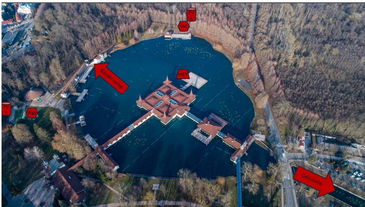
1. ábra. A Hévízi-tó vízháztartási mérlegéhez szükséges mérési helyszínek. TV5, TV7: talajvíz kutak, Wgy, Wl talajnedvesség- és vízhőmérséklet-mérés, MET meteorológiai állomás.
