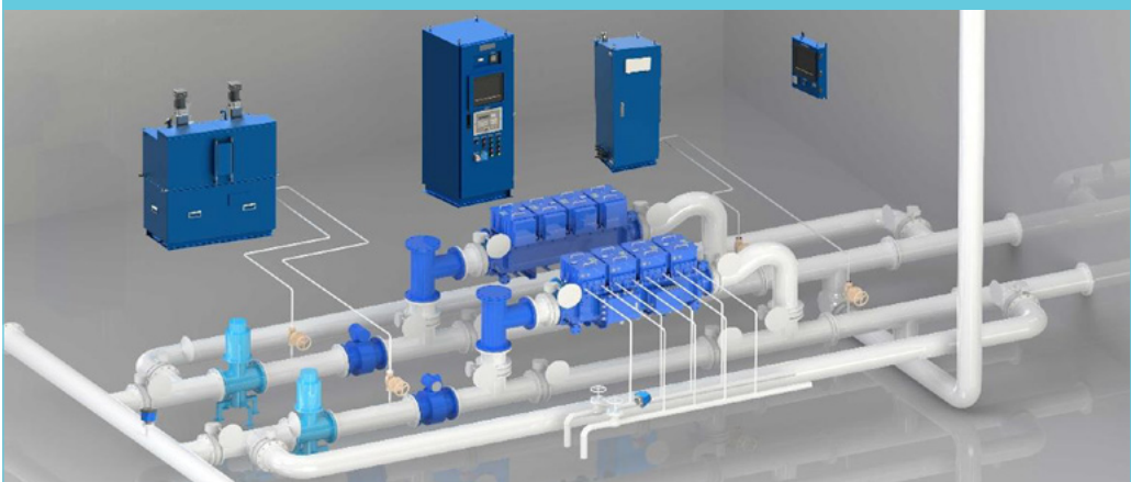
1. ábra: A ballasztvíz-rendszer térbeli vázlatrajza [8]
