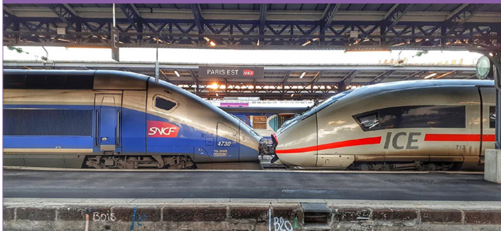
9. ábra: SNCF TGV és DB ICE fizikai összekapcsolása lehetséges, viszont a két szerelvény vezérlése nem egységesített. [11]
