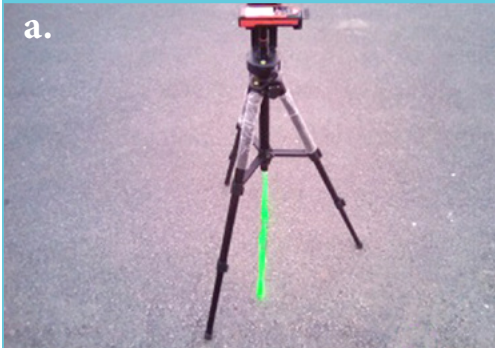
5. ábra: A 100m-es szakasz és a szintkülönbség kimérése (a) lézeres távolság mérő, (b) célpont, (c) a mért távolság (d) a szintkülönbség (e) a burkolati jeltől mért távolság. (saját szerkesztés)
