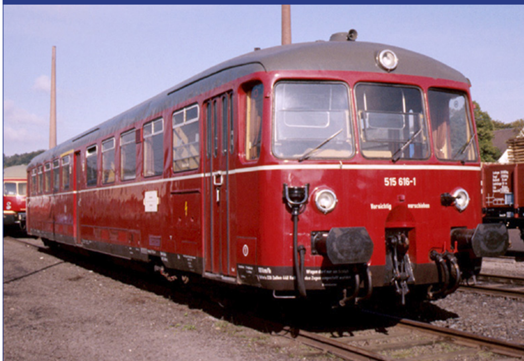
1. ábra: A DB 515-ös sorozatú akkumulátoros motorkocsija
