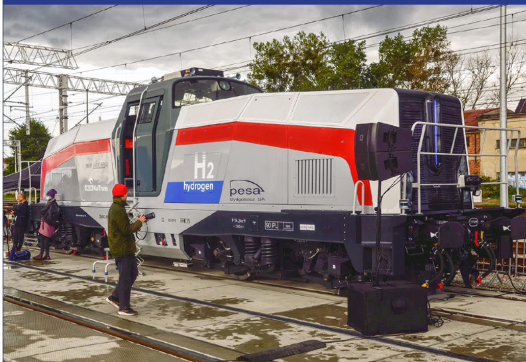
3. ábra: A lengyelországi PESA járműgyár SM42-6Dn típusú, hidrogénhajtású tolatómozdonya [forrás: iho.hu]
