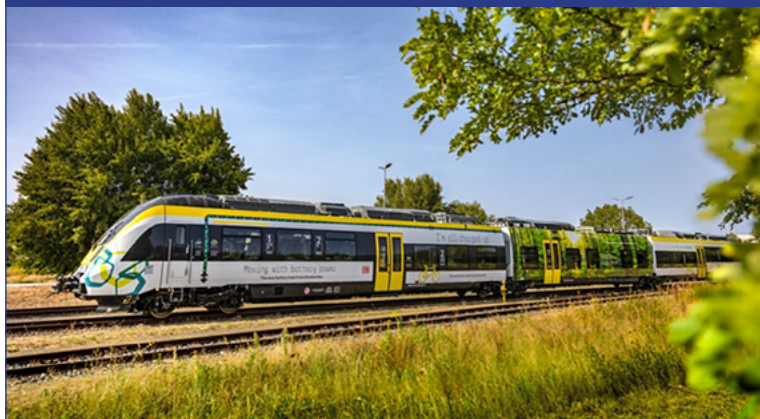
2. ábra: Az Alstom Talent 3-asának akkus-villamos üzemű prototípusa [forrás: insideEVs.com]
