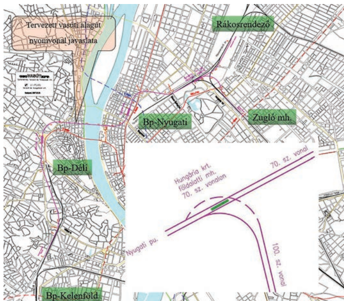
51. ábra: Vasúti alagút nyomvonaltanulmány (forrás: GEOVASÚT Kft.)
