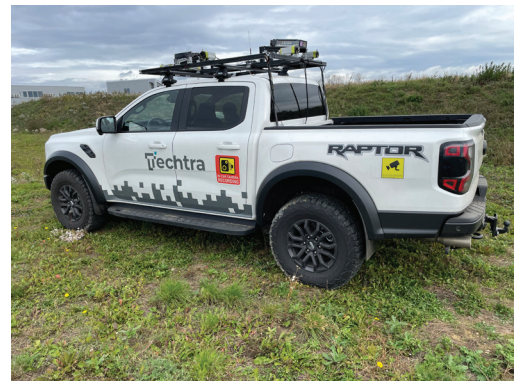
2. ábra: Felszenzorozott mérőjármű
