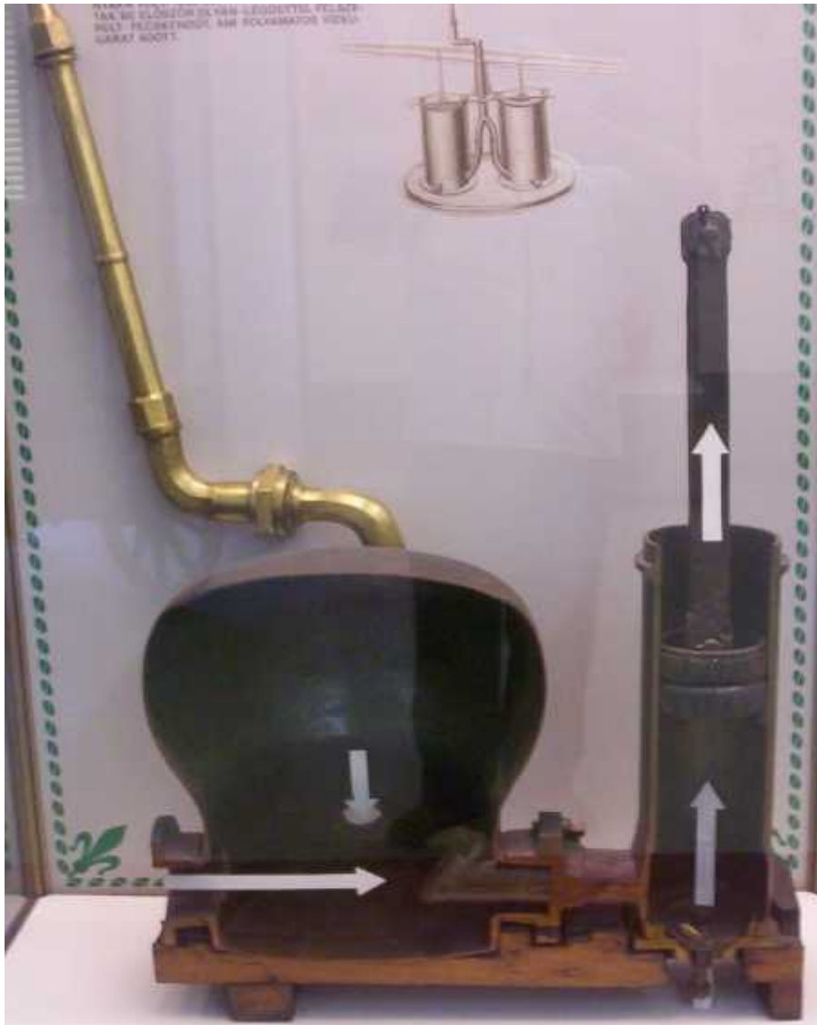
2. kép. A szélkazán m ködését szemléltet metszet. (Háttérben a hattyú- vagy gólyanyak, /egy része takarva/.).
