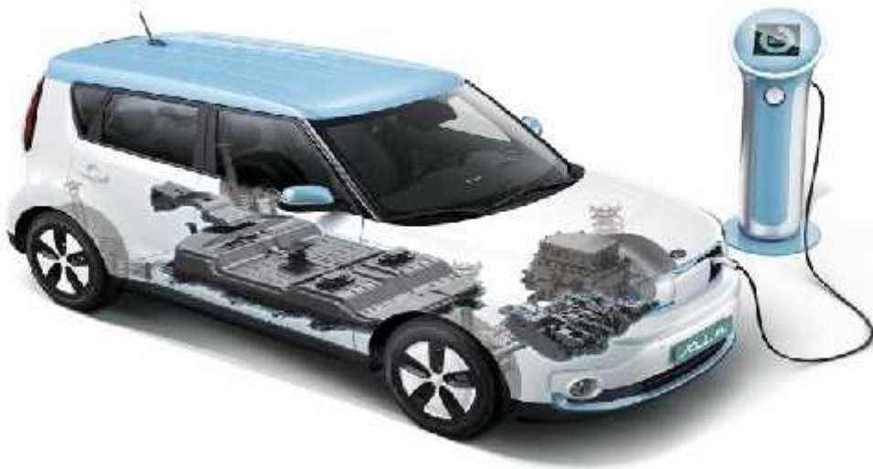
2.ábra 2 : Elektromos jármű akkumulátorának elhelyezkedése
