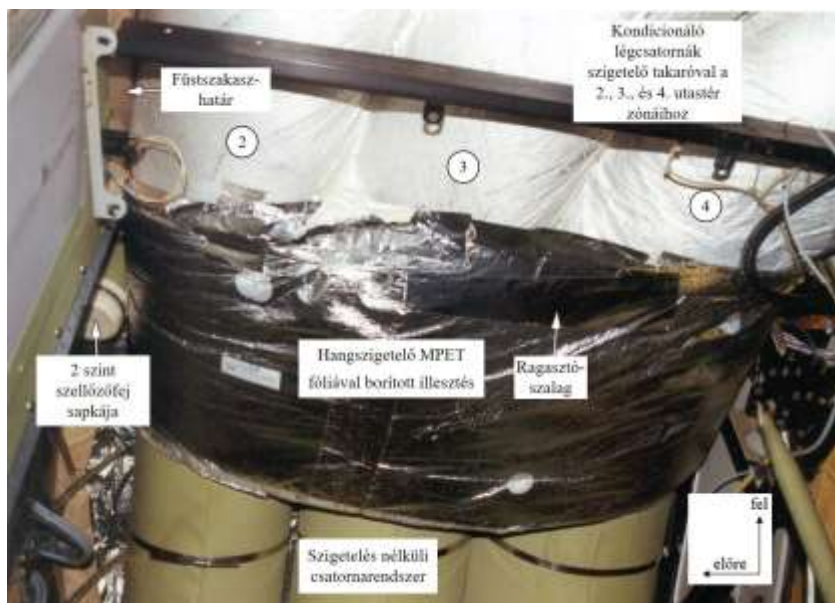
1. ábra: MPET hangszigetelő fóliaborítással fedett illesztés 4
