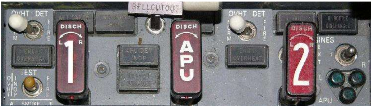
5. kép: A Boeing 737-es oltórendszerének kezelő panelje [35]
