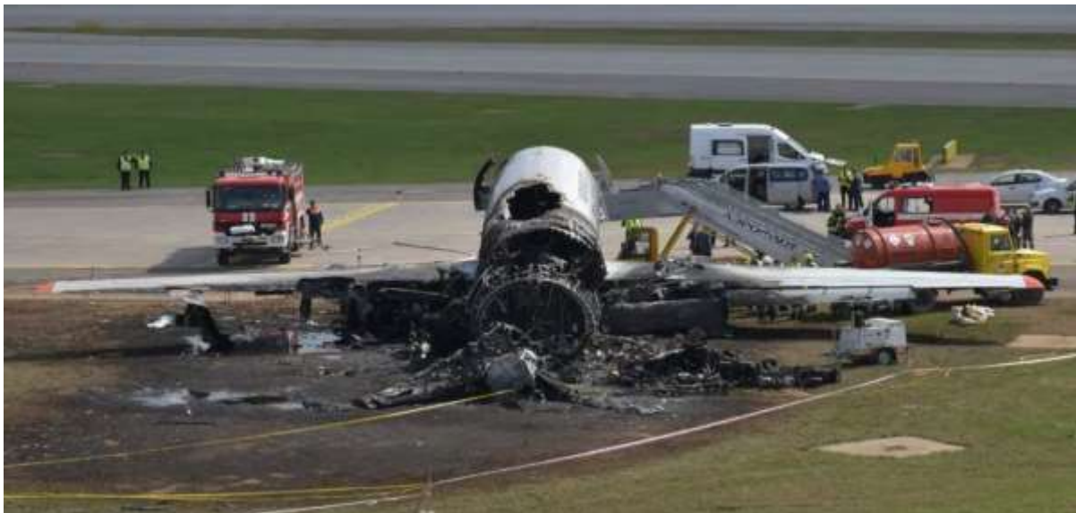
1. kép: Az RRJ-95B gép szárny mögötti részének károsodása hátulnézetből [15]
