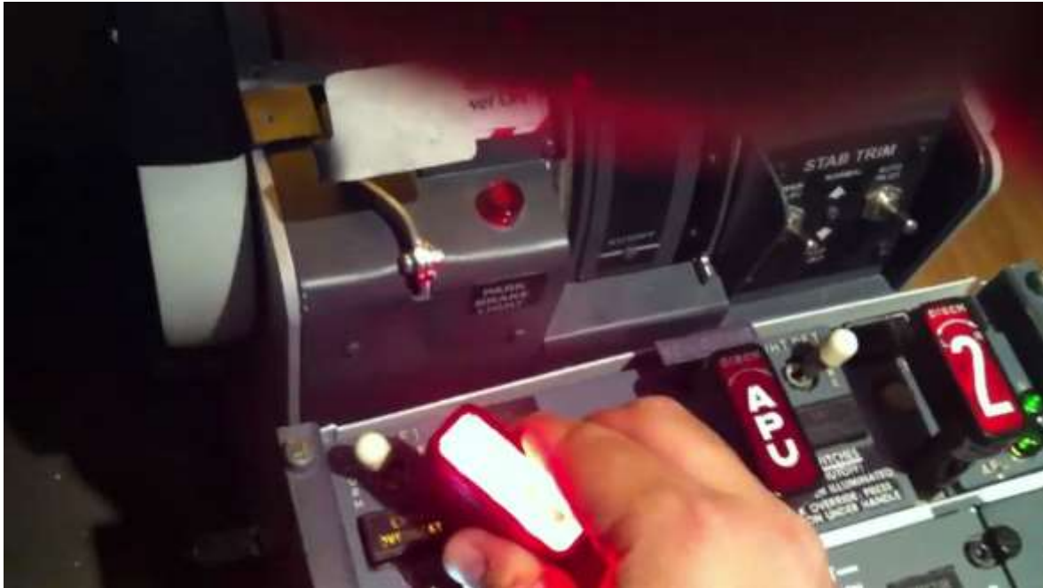
7. kép: Boeing 737 "1"-es hajtómű tűz oltása
