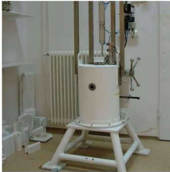
1. ábra: Besugárzó berendezés, több sugárforrás pozícióval. Forrás: [5]
