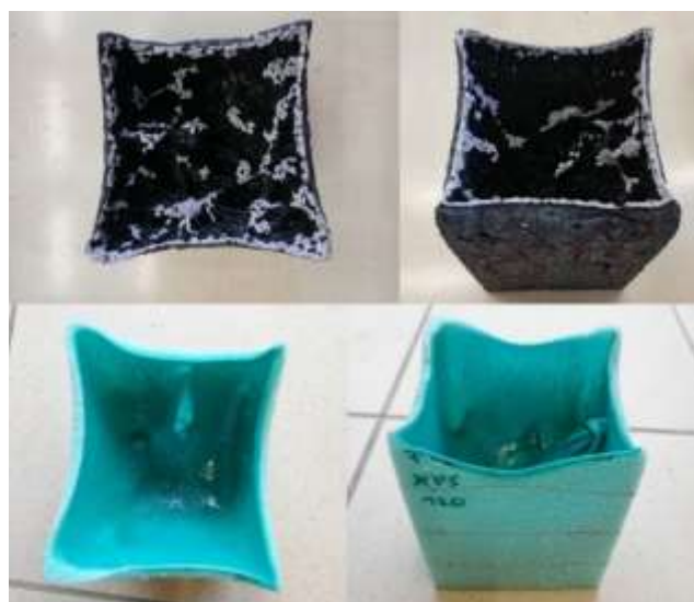
9. ábra: Polisztirolok alakváltozása sugárzó hő hatására (GPS fent, XPS lent) (forrás: szerzők összeállítása)
