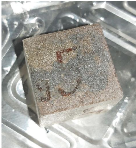
7. ábra: 900 °C hőmérsékleten hőterhelt, bórkarbid kiegészítőanyag tartalmú próbatest
