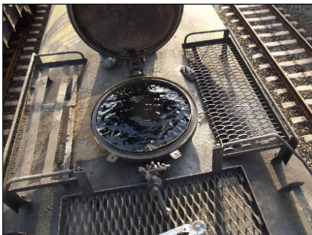
4. kép: Benzint szállító túltöltött vasúti tartálykocsi (Forrás: Szabolcs-Szatmár-Bereg VMKI)
