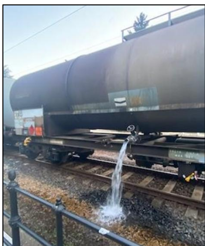
2. kép: Etilalkoholt szállító vasúti tartálykocsi megnyitott lefejtő szerelvénye (Forrás: Győr-Moson-Sopron VMKI)
