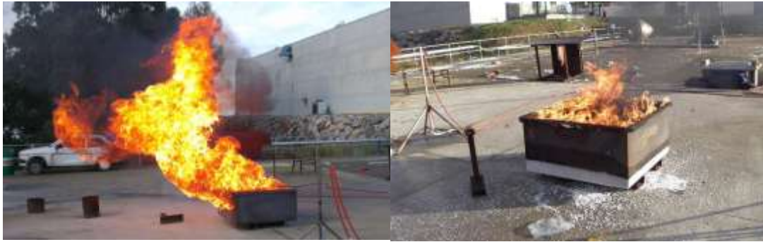
4. és 5. fénykép: LNG-tűz intenzitásának csökkentése DryFoam alkalmazásával: Kísérleti tűz kipárolgás csökkentő anyag nélkül és szárazhab réteggel [6]
