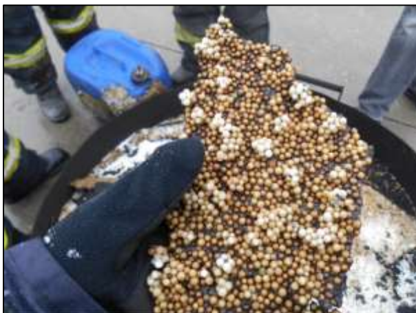
2. fénykép: A szárazhab-kéreg [6]
