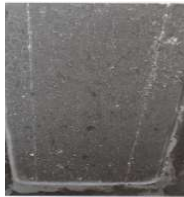
5. ábra: Műanyag száladagolással készült lemez felülete 2 órás tűzteher után [21]
