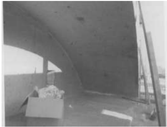
3. ábra: 2 kg/m 3 polipropilén száladagolással készült alagútelem 1200°C-os hőterhelés után [25]
