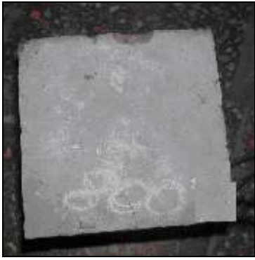
7. ábra: A beton felülete a 800 °C-os hőterhelést követően (betonösszetételt lásd 1. táblázatban )
