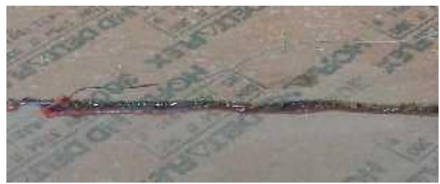
4. ábra: 174 °C és 40 amper forr a m anyag, égve csepeg. 185 °C és 38 amper végig feketedik. Forrás: szez k
