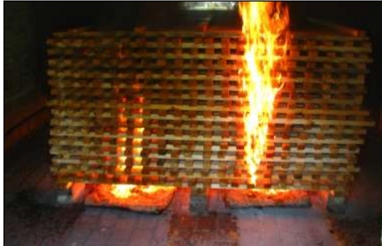
3. kép. A 650 kg fenyőfa lécek tüzelőanyag közvetlenül gyújtás után.
