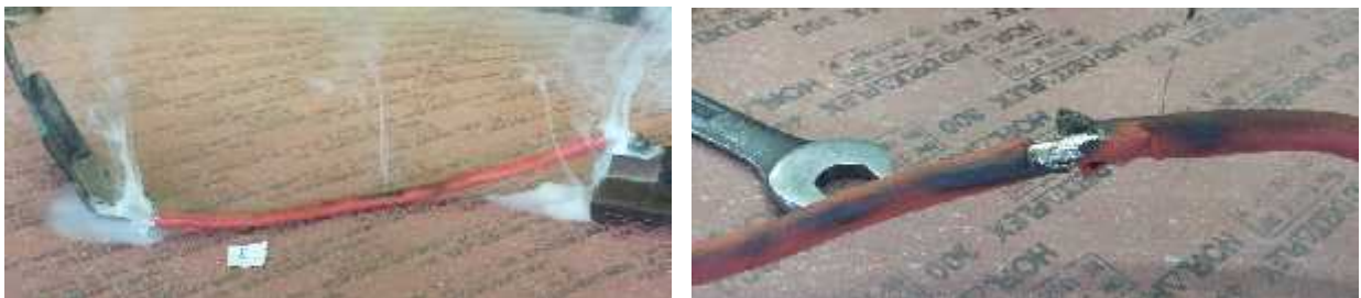
3. ábra: Viselkedés: Pipál, ill. buborékosodik a szigetelés. 38 ampernél és 189 °C-nál.
