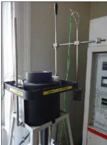
1. ábra: Neméghetőségi vizsgálathoz használt kemence és vezérlőegység (YMÉK Tűz és katasztrófavédelmi Intézet, Tűzvédelmi labor)
