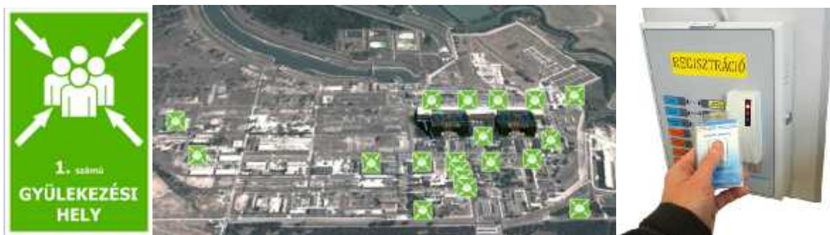
1. ábra. Gyülekezési helyre figyelmeztető tábla (bal oldal), gyülekezési pontok a telephelyen (középen), regisztrációt segítő blokkoló óra, forrás: PA Zrt.
