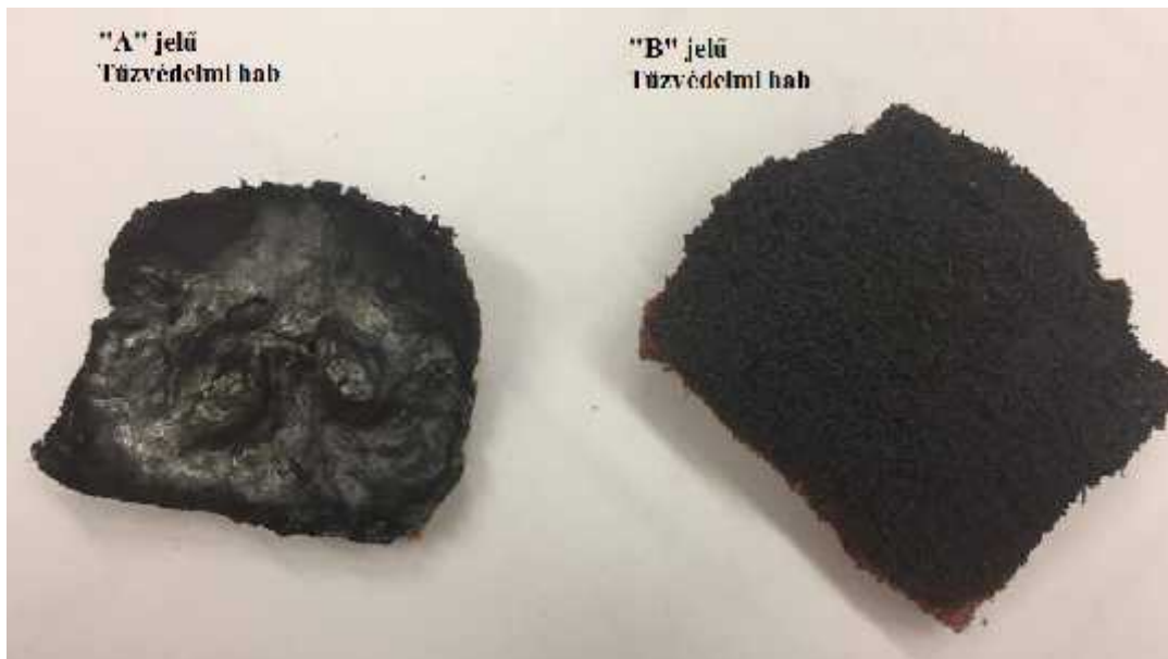
8. ábra: Vizsgálat utáni állapot: méretzsugorodás és elszénesedés
