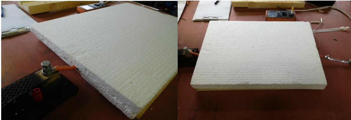
5. Kép: NhXh-J3x1,5 E90-es tűzálló kábel EPS szigetelésben elvezetve
