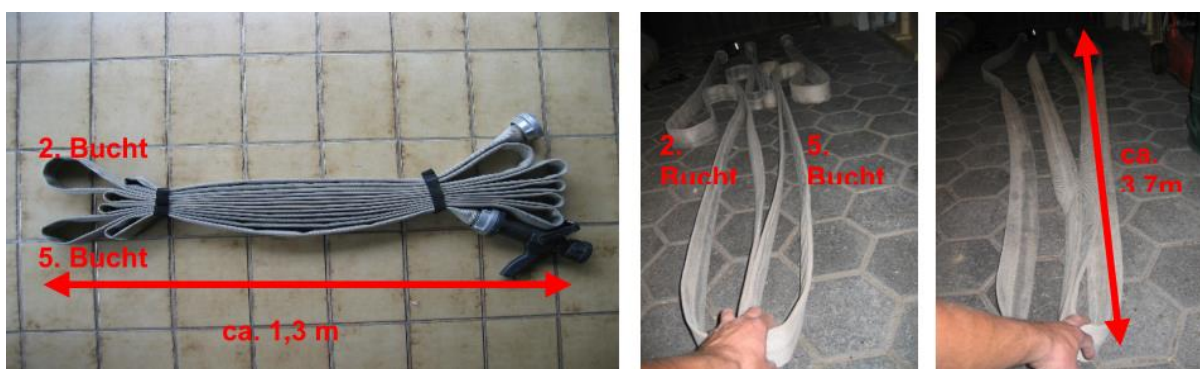
2. kép: az öblökbe hajtogatott tömlőcsomag és széthúzása tömlőtartalékká [18]
