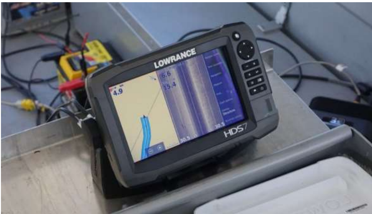
1. ábra. Lowrance® HDS-7" Gen3 Touch kijelző és szonárvezérlő, jobb oldalán a nyitható microSDHC™ kártyahelyekkel. A kijelző bal paneljén az aktuális mérés által lefedett terület látható, bal felső sarkában a pillanatnyi haladási sebességgel, még a jobb panel a csónak alatti mederfenék oldalpásztázó szonárképét mutatja. Ezen panel bal felső sarkában a vízmélység és a víz hőmérséklet is leolvasható.
