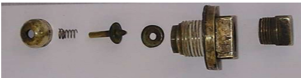
11. számú kép: A töltőszelep alkatrészei (Forrás: KVKM fotótára)
