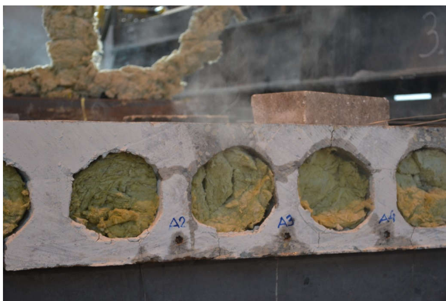
3. A körüreges födempallón vízszintes repedések jelenek meg a tűzvizsgálat 18. percében (6. ábra)
