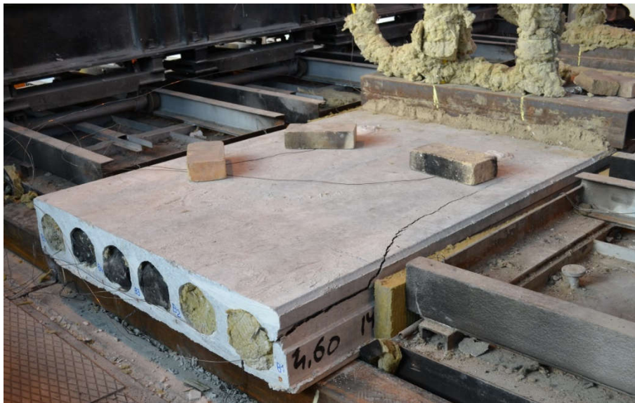
4. ábra: A körüreges földémpalló első repedése a tűzvizsgálat 5.-6. percében (2017. 12. 07.)
