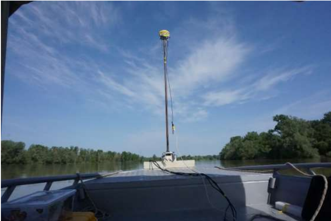
3. ábra. A mérőrendszer felépítése. A rudazat három méter hosszú, tőben hátra hajtható, közepén szétcsavarható. Tetején egy GeoMax® Zenith35™ Pro Rover ül, az alsó, vízbe merülő részén pedig a 2. ábrán látható szenzorok vannak. A kábelek a vezető állásban lévő központi kezelőszervhez tartanak (1. ábra).
