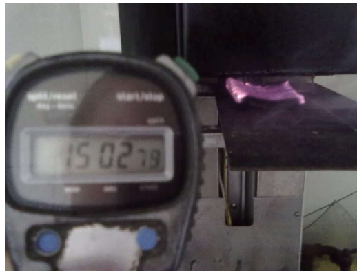
13. kép: Kísérlet közben KAL VK 1 sugárzó hő vizsgálatára szolgáló műszerrel
