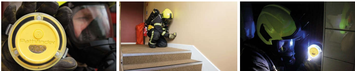
1. kép: A Pathfinder tárcsa egy kis füstérzékelő méretének felel meg. Intelligens technológiát használ az épületen belüli tűzoltók mozgásának nyomon követésére. A megfelelő méretű nyomkövető szenzor, a tűzoltó sisak belsejében található, és kommunikál az egységgel. [13]
