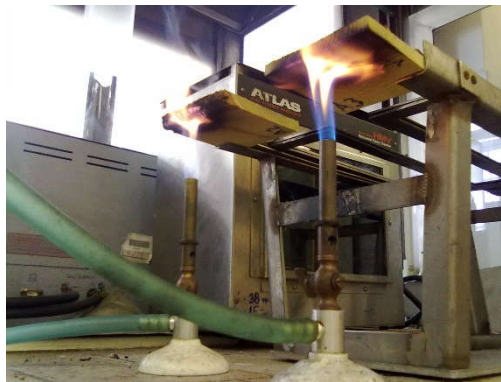
10. kép: Minták elhelyezése direkt lánggal történő vizsgálatban
