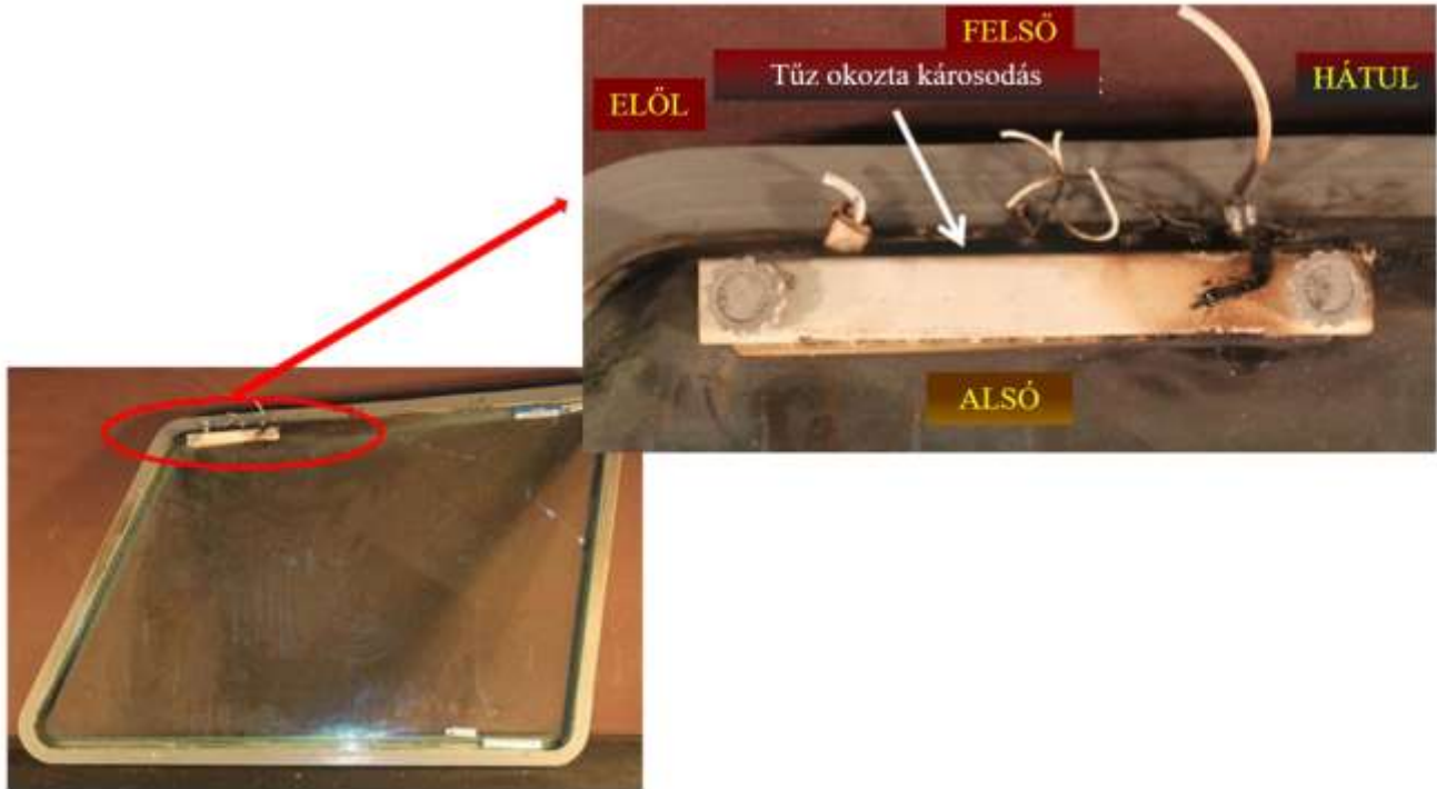
4. ábra: A szélvédő fűtési rendszerén keletkezett ív nyomai 5
