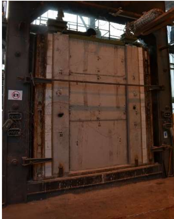
4. ábra: Falpanel a beépítés után (fotó Szentendre ÉMI)
