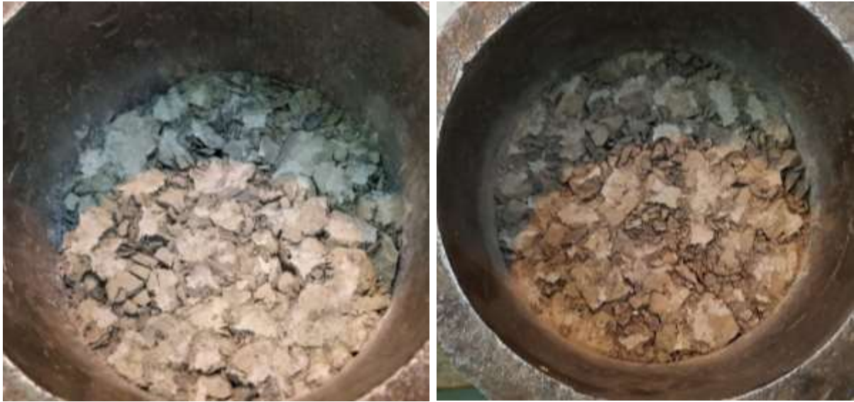
9. ábra: Hummel mozsárban megzúzott referencia (20 °C) (bal) és 800 °C-on hőterhelt (jobb) andezit minták
