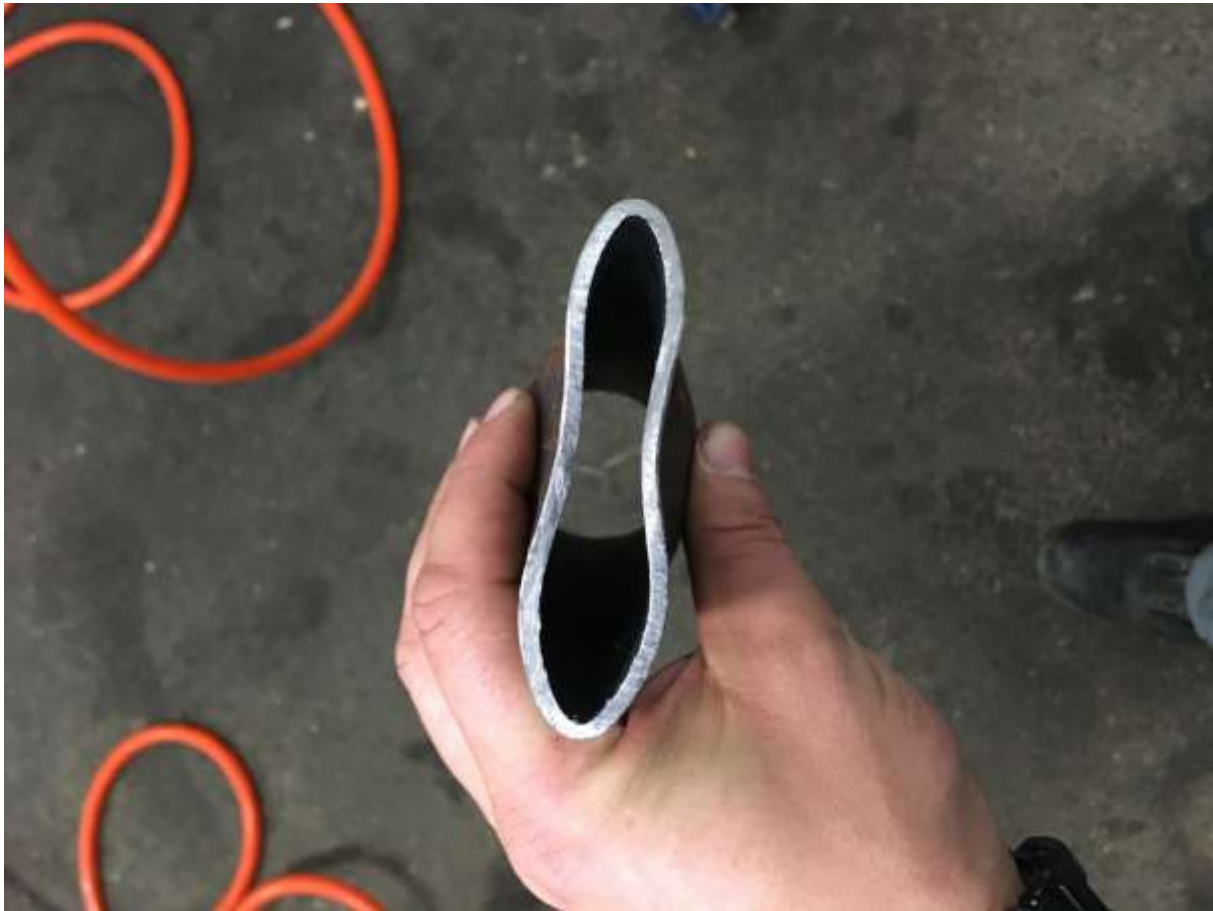
7. ábra A nem hűtött szorítás eredménye
