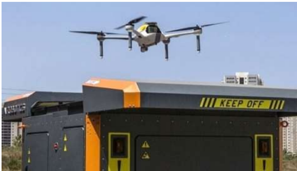
2. ábra. Terepi autonóm drón állomás töltési és tárolási megoldással. Forrás: Airobotics [7]
