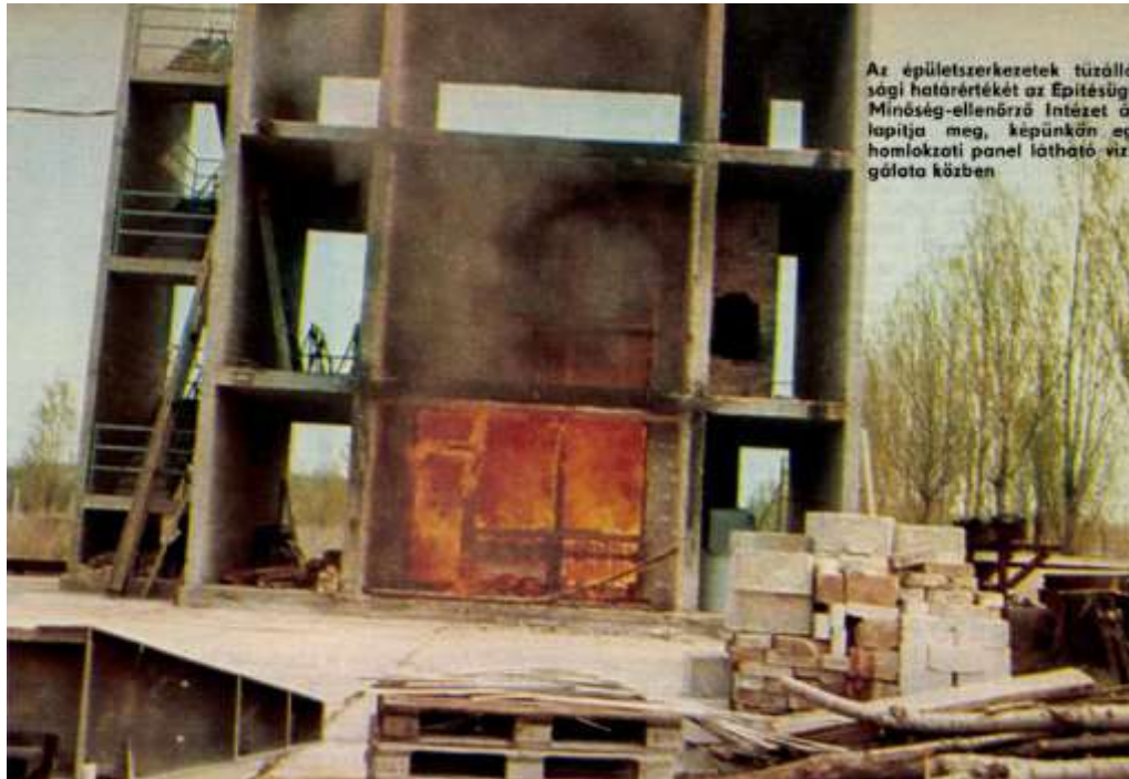
2. ábra: Az ÉMI homlokzatvizsgáló berendezése működés közben az Élet és Tudomány folyóirat cikkében [11]
