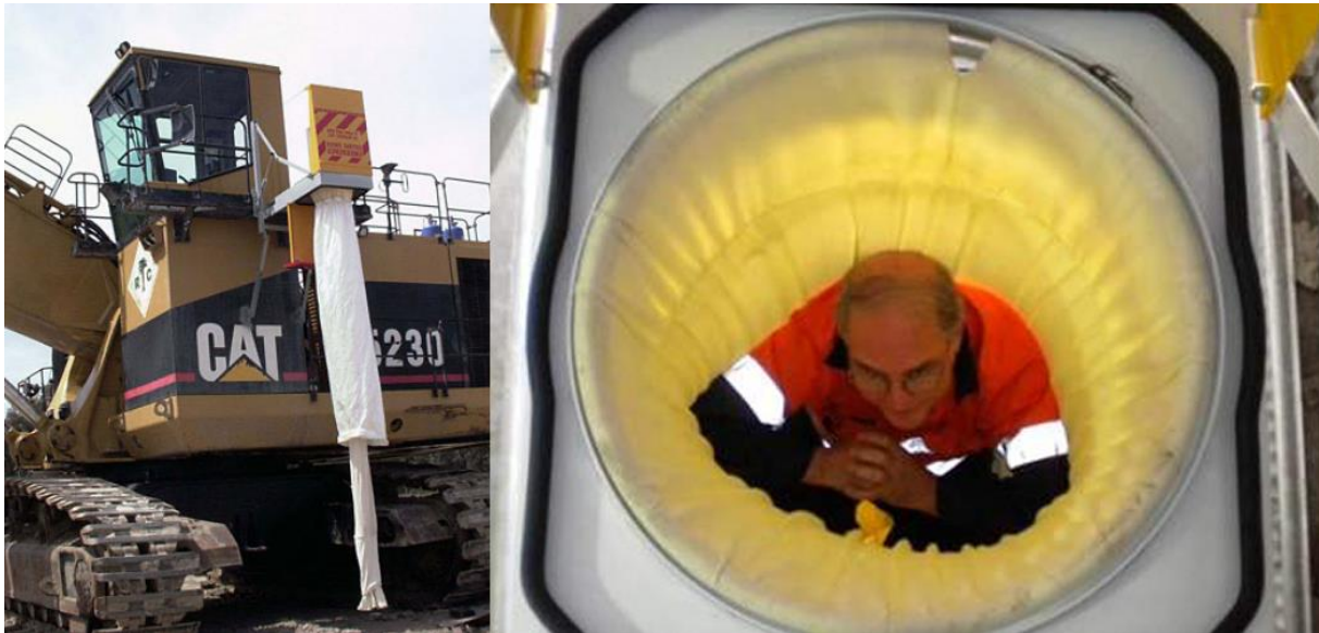
30. ábra: Beépített mentőtömlő egy kotrógép oldalán. 14
