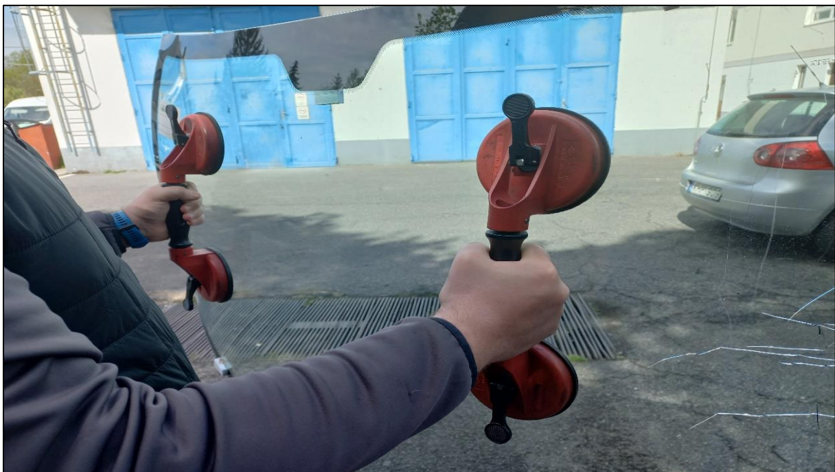
8. kép: Egy törött szélvédő megemelése, és stabilan tartása (készítette a szerző)
