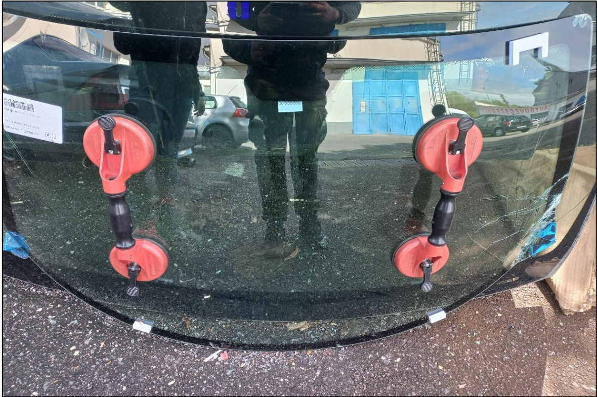
20. kép: A vákuumos emelők felhelyezése (készítette a szerző)
