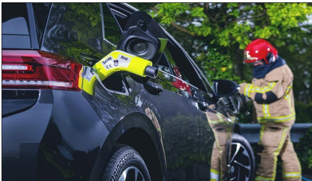
7. kép: Az Emergency Plug készülék használat közben (Forrás: ld. [6])
