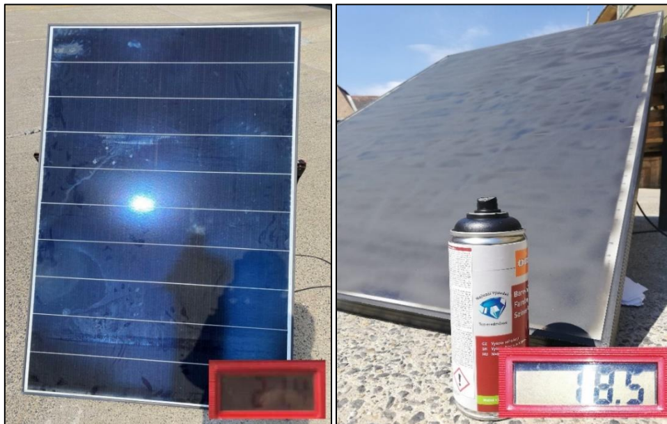
5. kép: Feszültségmérés a napelemek festékekkel történő lefújását követően (készítette: a szerző)
