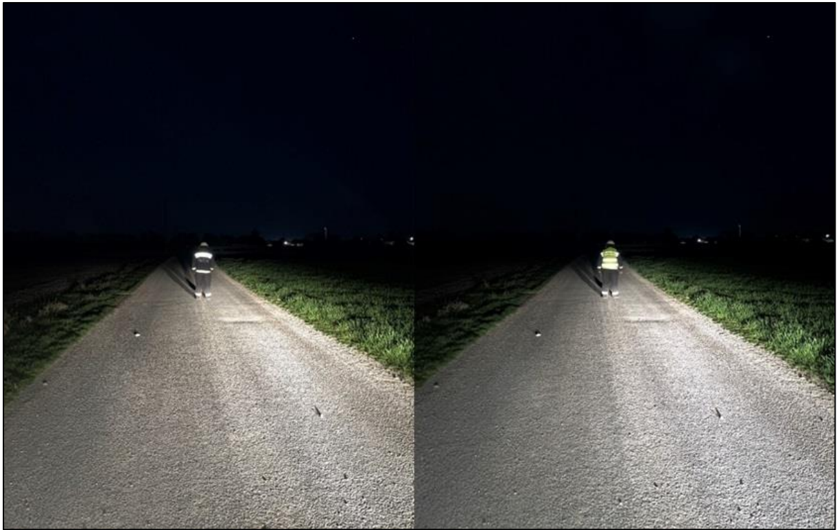
4. kép: bevetési védőkabát és a láthatósági mellény, 15 méteres távolságból (készítette a szerző)
