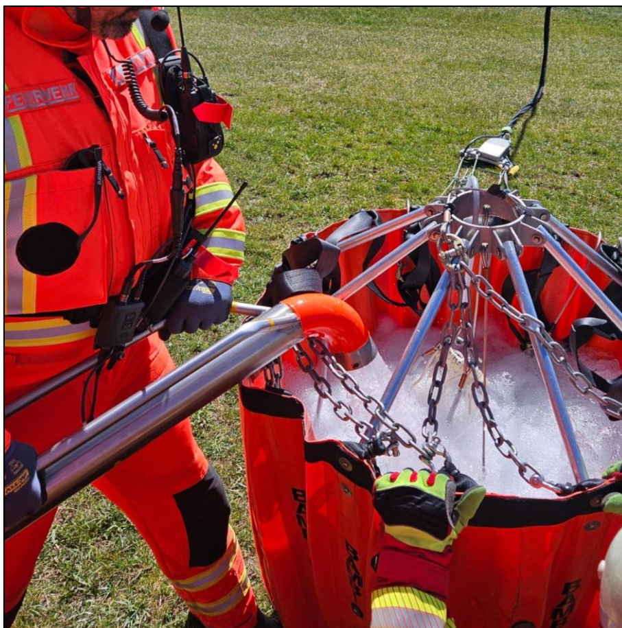
2. ábra: A LES GmbH által készített feltöltő cső alkalmazás közben. (Forrás: ld. [5])
